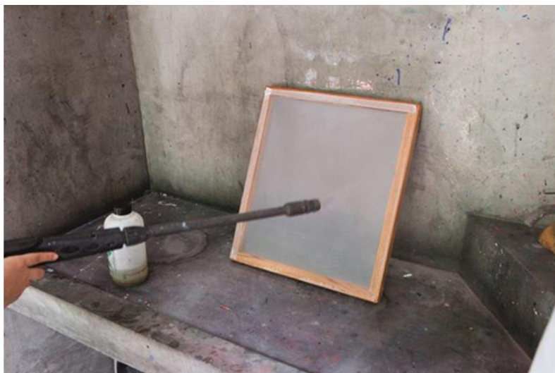
3.ทำความสะอาดผ้าซิลค์สกรีนด้วยสปูแรงดัน ผึ่งลมให้แห้ง
